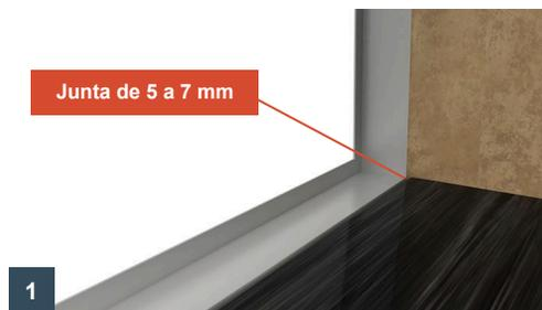
Prever uma junta de 5 a 7 mm entre o revestimento externo e o contramarco.
